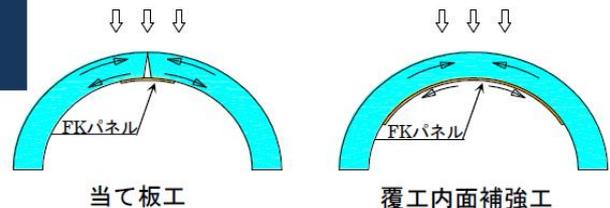
・・・連続炭素繊維シートによる覆工補強工法の特徴を活かして、繊維シート等の補強材を高強度・軽量且つ耐久性に優れた成型パネルを用いて、トンネル・橋梁、その他構造物等を補修・補強する工法である。また、炭素繊維内蔵パネル工法は、覆工コンクリートの剥落防止や塩害進行等を抑えるために表面のからの塩化物イオンの進入を防ぐ目的で繊維パネルをコンクリートパネルと一体化させる工法である。
